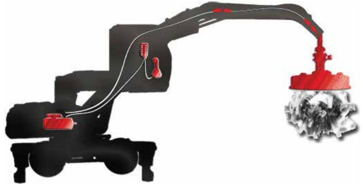
Uma das principais características do gerador hidráulico é a rápida desmagnetização dos materiais aderidos ao eletroímã e a “eliminação” de um painel retificador externo para alimentação VCC, pois o controle já está incorporado ao nosso gerador. Isso possibilita grande precisão e confiabilidade no manuseio de materiais ferrosos.
