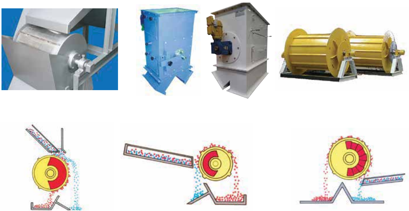
Figura 32: Sugestões de instalação de tambores magnéticos.
