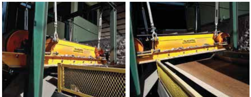
Figura 19: separador magnético e polia magnética trabalhando em conjunto com detectores de metais
