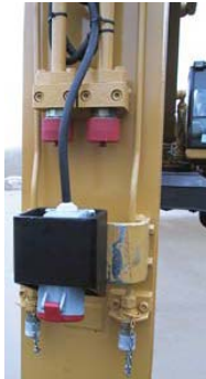
1.2 Soquete com capa protetora, a ser instalado no topo do braço da máquina
